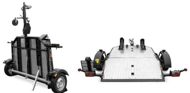
Motorradanhänger absenkbar mit einer Seilwinde.
